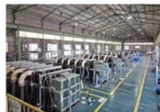
膜濃縮法//イオン交換膜電気透析槽 ～赤穂工場には23槽設置、塩生産能力：約23万トン/年～
